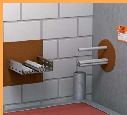
FBS90 2-K 2-компонентная огнестойкая пена Двухкомпонентная огнестойкая пена для создания проходок для кабеля и кабеленесущих систем без нанесения дополнительного покрытия. Также служит для создания проходок для труб из негорючих материалов.
