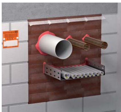
FBA-B200 Огнестойкие пеноблоки Огнестойкие пеноблоки для создания проходок при комбинированной прокладке электрического кабеля и санитарно-технических труб. Для прокладки труб из горючих материалов не требуется дополнительных манжет.
