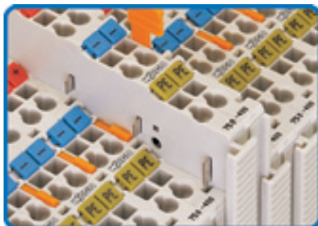
Надежное автоматическое соединение с помощью луженого самоочищающегося скользящего контакта; заземляющий контакт замыкается первым и размыкается последним (серии 750 и 753)
