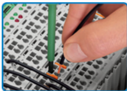
Пример монтажа проводов, система WAGO-I/O-SYSTEM 750
