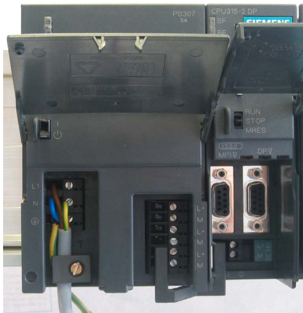
Рисунок 5-1 Электрический монтаж блока питания и CPU
