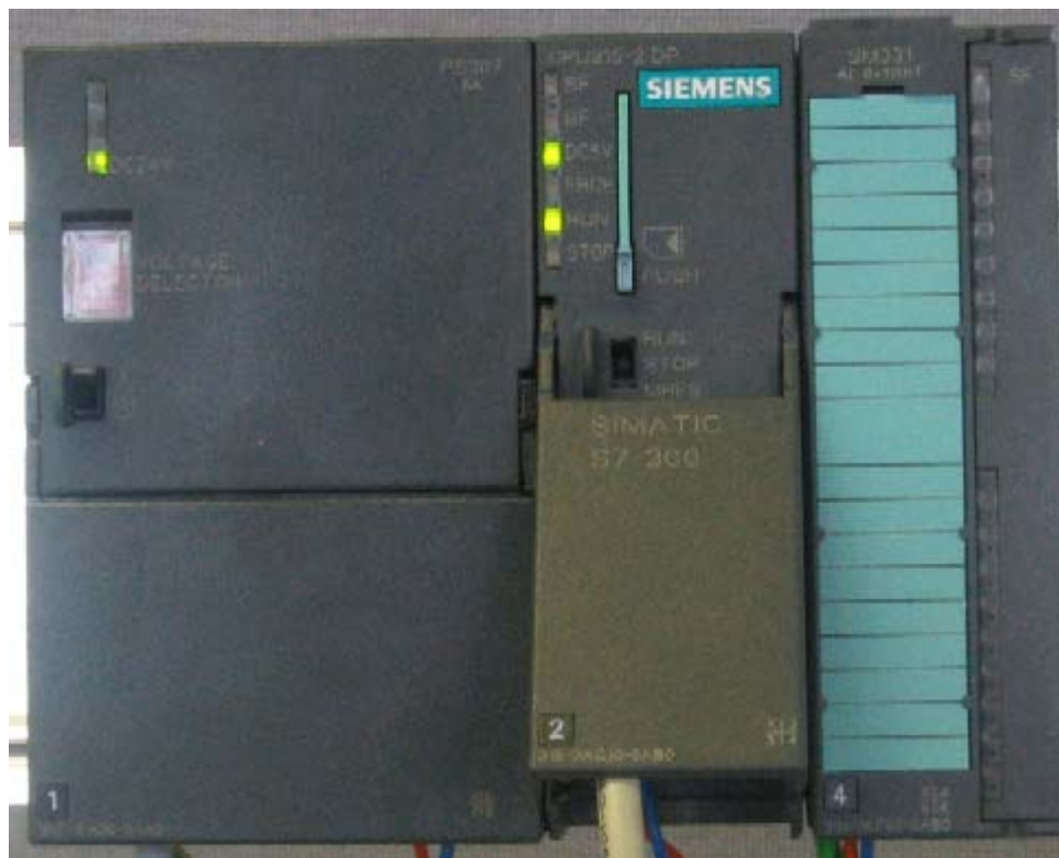
Рисунок 6-3 CPU в нормальном режиме работы (без ошибок)
