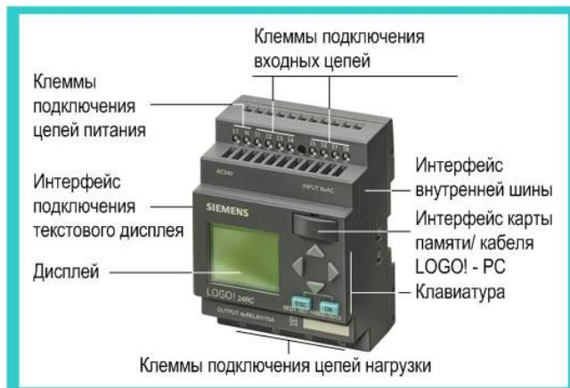
Логические модули LOGO! выпускаются в пластиковых корпусах размерами 72 x 90 x 55 мм и имеют степень защиты IP 20. Каждый модуль оснащен:
