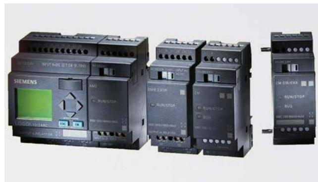
Универсальные логические модули LOGO! являются компактными функционально законченными изделиями, предназначенными для построения наиболее простых программируемых устройств автоматического управления:
