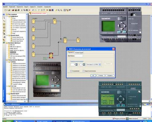
Разработка программ логических модулей LOGO! может выполняться с помощью пакета LOGO!SoftComfort, установленного на программаторе или компьютере. Пакет LOGO! Soft Comfort работает под управлением операционных систем Windows 2000/ XP/ Vista, Linux и MAC OS X. Он может быть использован в клиент/ серверных приложениях и обеспечивает максимальное удобство разработки, отладки, документирования и архивирования программ логических модулей LOGO!
